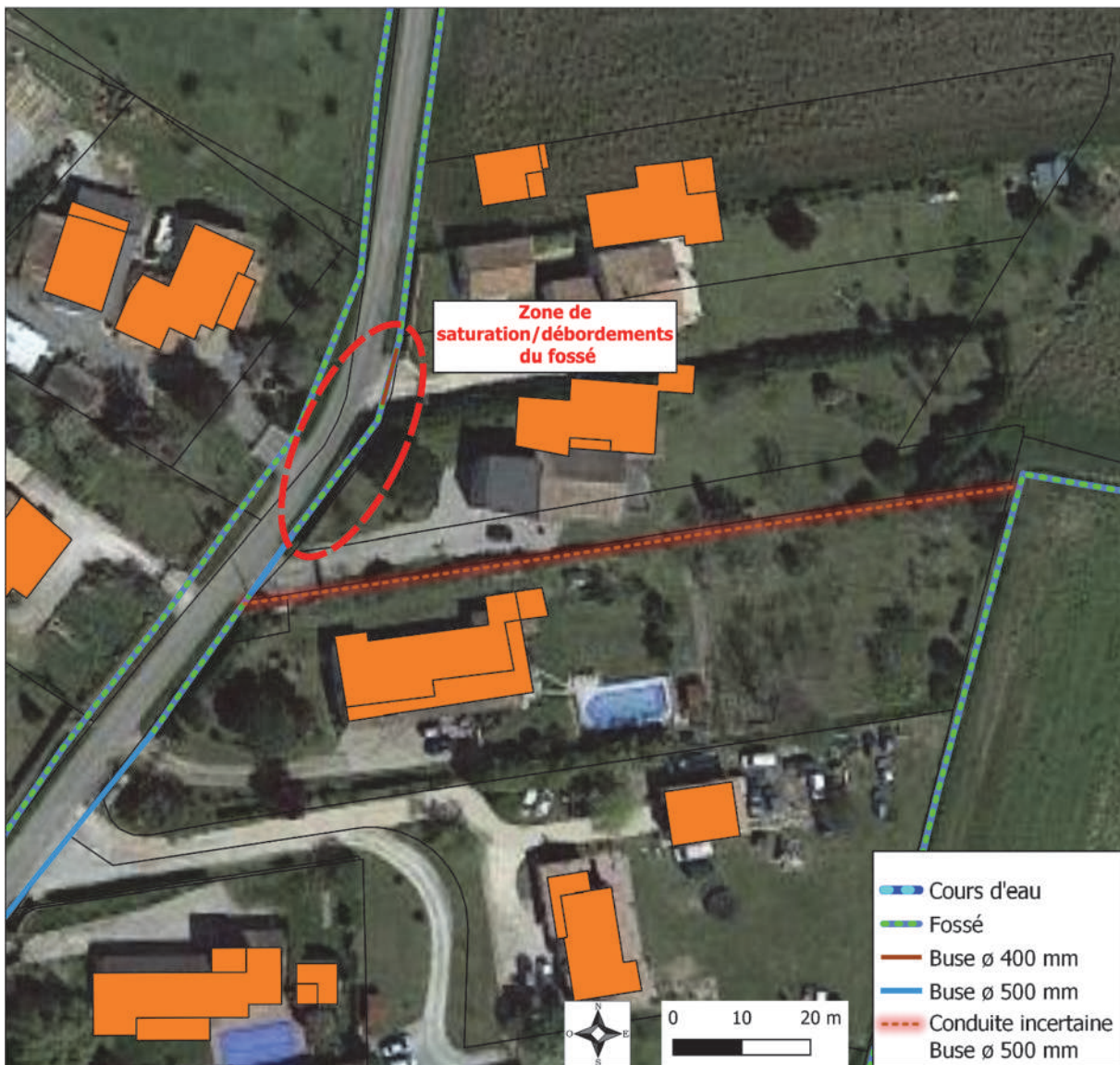
Figure 8 - Localisation point de dysfonctionnement Fossé de la RD64B
