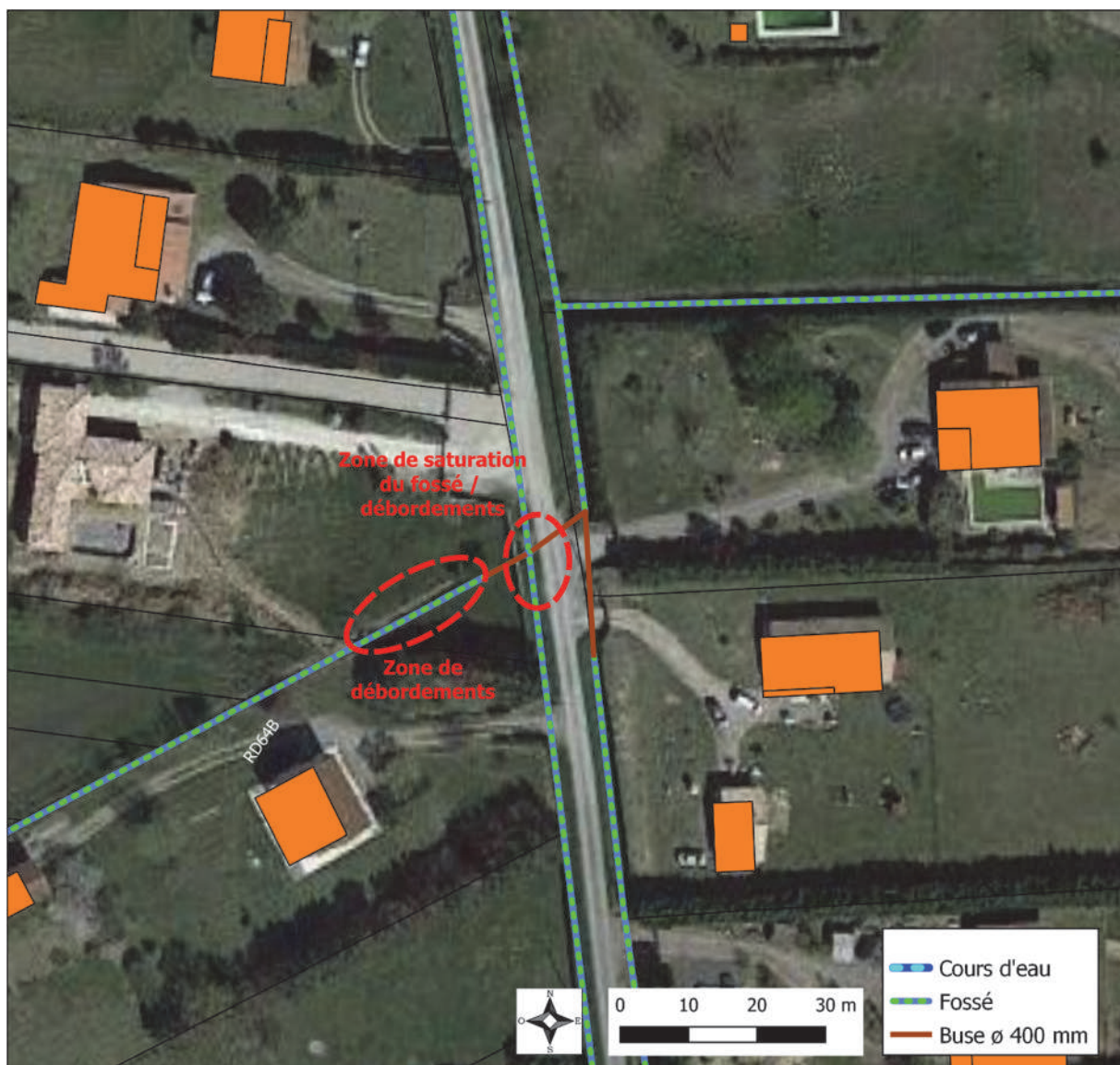
Figure 9 - Localisation point de dysfonctionnement Chemin du Grenadier
