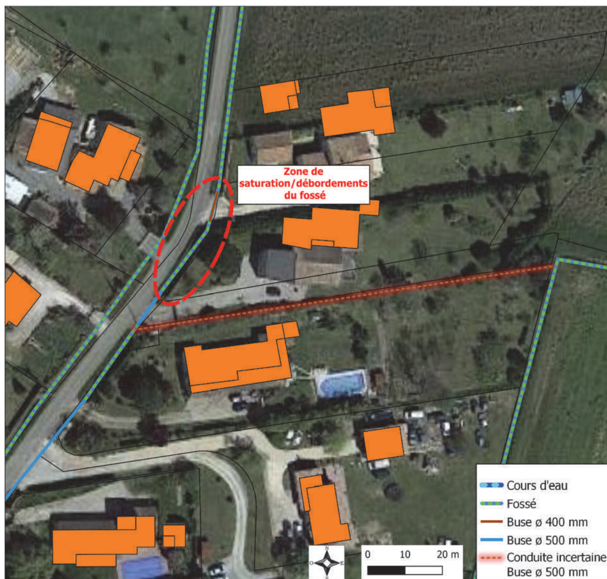
Figure 12 : Localisation point de dysfonctionnement fossé de la RD64B
