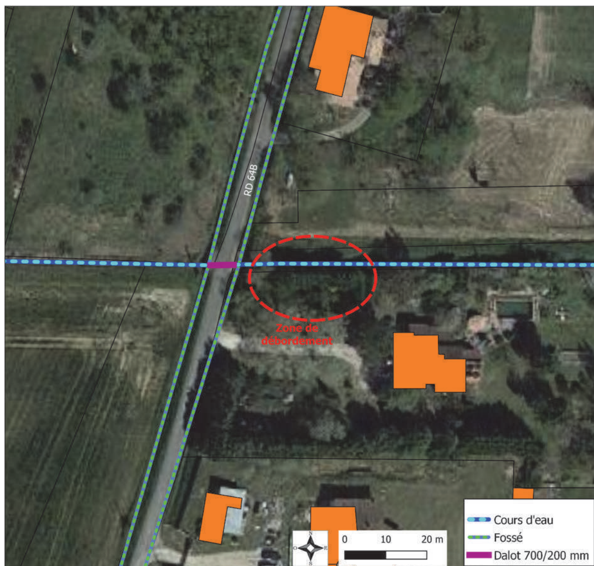
Figure 9 : Localisation point de dysfonctionnement aval RD64B
